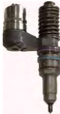
Pumpe-Düse mit elektrischen Hochdruck-Magnetventils
